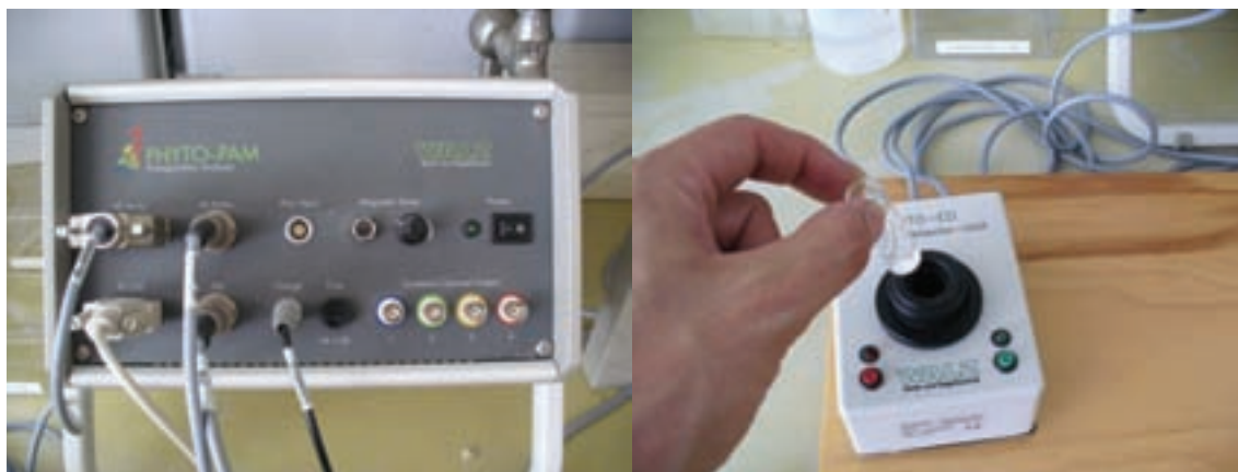
FIGUUR B2.1 DE PHYTO-PAM PHYTOPLANKTON ANALYZER (LINKS) EN CUVETHOUDER (RECHTS)
